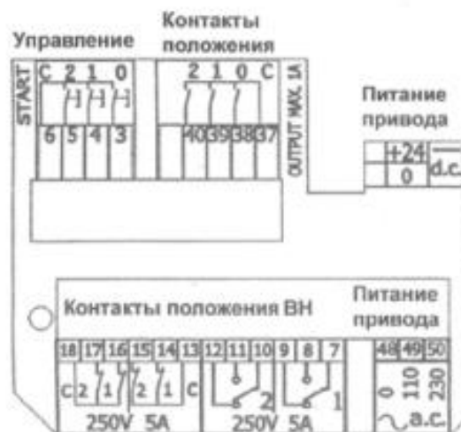
Рис. 1.5 Схема подключения CS5MS
